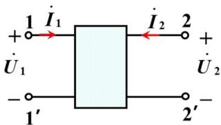
类比一端口网络端口阻抗的求法
