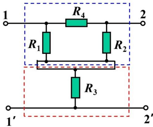
$$Z_2 = \begin{bmatrix} R_3 & R_3 \\ R_3 & R_3 \end{bmatrix}$$
