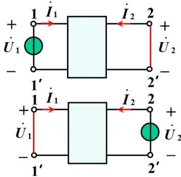
互易二端口 激励无论加在哪侧，对侧产生的响应都一样
